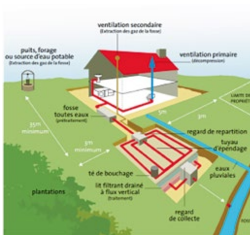
Principe de l'assainissement non collectif
