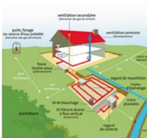
Principe de l'assainissement non collectif
